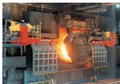
شکل (۱-۵): ریختن مذاب در قالب های شمش ریزی
