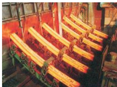
شکل (۴-۵): شمش ها در حین خروج از کوره ی تولید
