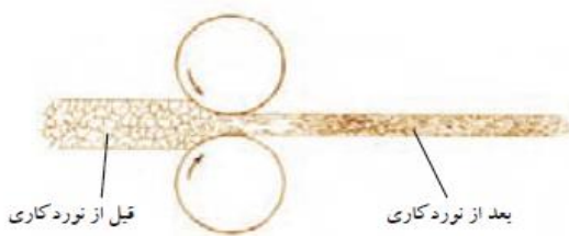
شکل (۳-۴): مقطع فولاد قبل و بعد از نوردکاری
