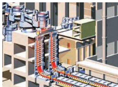
شکل (۳-۵): نوردهای سری در خط تولید ورق
