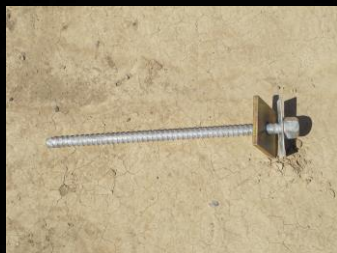
قطعه داخل دیوار برای محکم و ثابت شدن قالب
