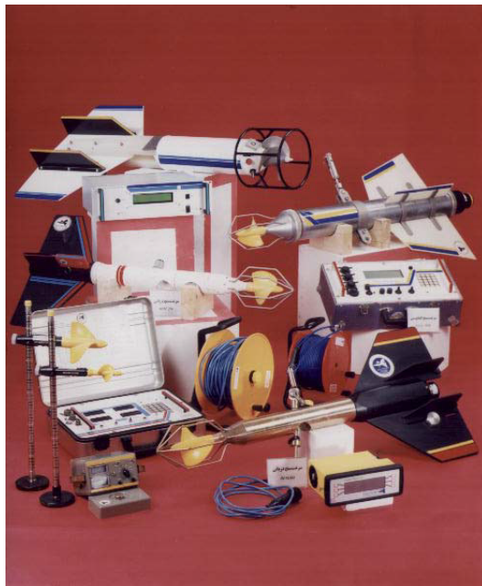
شکل ۷- نمونه‌هایی از جریان‌سنج‌های پروانه‌ای دریایی و رودخانه‌ای
