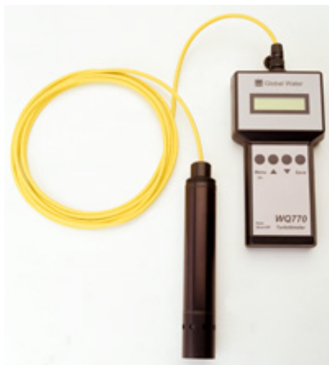
شکل ۱۳- نمونه‌ای از یک دستگاه کدورت‌سنج
