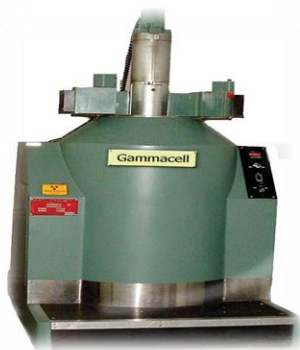
شکل ۱. شمای فنی و تصویری دستگاه گامای درون کار خشک (گاماسل ۲۲۰)
